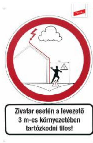
Védelmi intézkedés veszélyes érintési feszültség ellen
