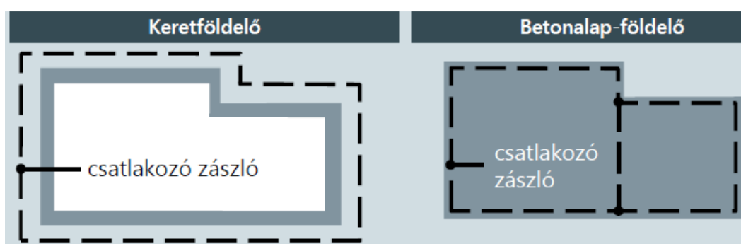
Keret- és betonlap-földelő, mint „B” típusú földelőrendszerek
